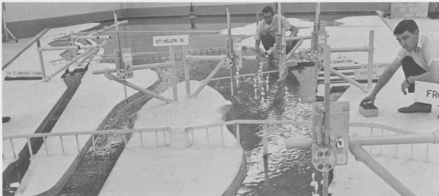
Aperçu d'une section du modèle hydraulique, où des flotteurs lumineux sont utilisés pour aider à déterminer la vitesse du courant près de l'île Sainte-Hélène. Un technicien, à droite, enregistre les vitesses à l'aide d'un chronomètre.
