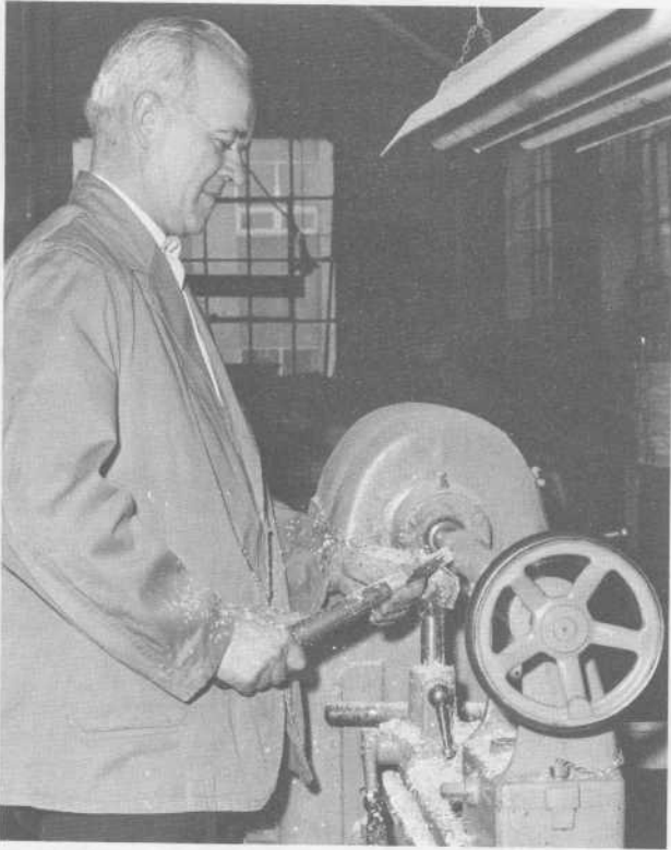
Charles-Édouard Simard est photographié au travail dans l'atelier de l'Agence de la marine du ministère des Transports, à Québec. Il est en train de tailler une pièce de bois qui servira à la construction d'un modèle de phare.
