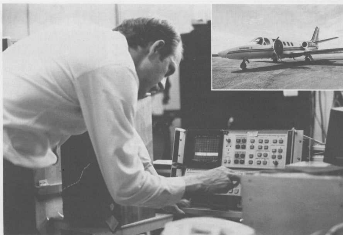
John Sydor, un ingénieur des systèmes mobiles de communications par satellite, procède à l'essai de l'appareil qui est installé dans l'ambulance aérienne tel que le "Bandage 4" (petite photo), un des nombreux avions à réaction et des hélicoptères utilisés par les auxiliaires médicaux pour fournir les premiers soins dans les régions éloignées.
