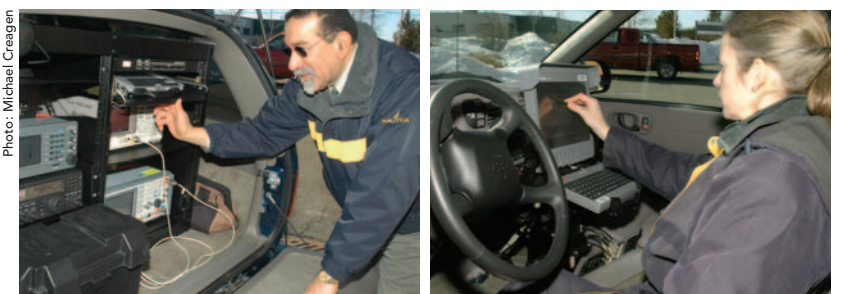
Photo: Michael Creagen L'agent de gestion du Spectre, Manuel Escobar, montre l'équipement électronique à l'arrière du véhicule mobile de surveillance qui est observé à distance par l'ordinateur de l'agent de gestion Gwen Arthurs, qui occupe le poste d'opérateur à l'avant du véhicule.
